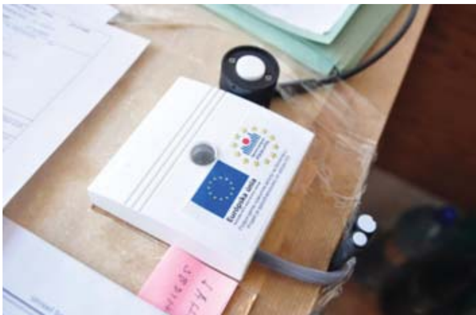
Obr. 3 – Detailný pohľad na prístroje zaznamenávajúce osvetlenie na pracovnom stole fakulty STU na 6. poschodí orientovanej na severovýchod. Merania sa realizovali na konci zimy a na jar v roku 2014. Pohľady na meraciu zostavu v exteriéri a v kancelárii sú v obr. 2. V exteriéri sa v krátkych časových krokoch zaznamenávala horizontálna osvetlenie štandardnými luxmetrami (LI-COR, senzor LI-210), globálne slnečné žiarenie (pyranometer Kipp & Zonen CMP 6) a spektrálne zloženie denného svetla sa merala spektrofotometrom Konica Minolta CL-500A krytým kupolou z číreho polykarbonátu s činiteľom prechodu svetla 0,90.
